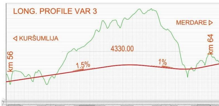
Slika 40 Varijanta 3 – Podužni profil od km 56+000 do km 64+000
